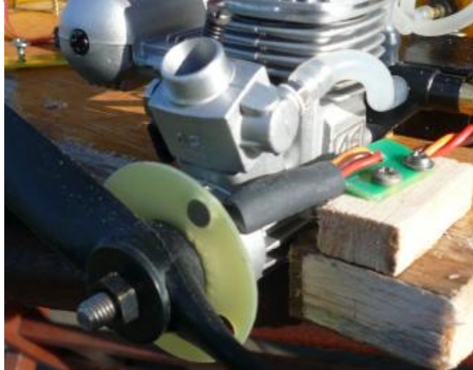
Příklad uchycení držáku magnetů a Hallový sondy
